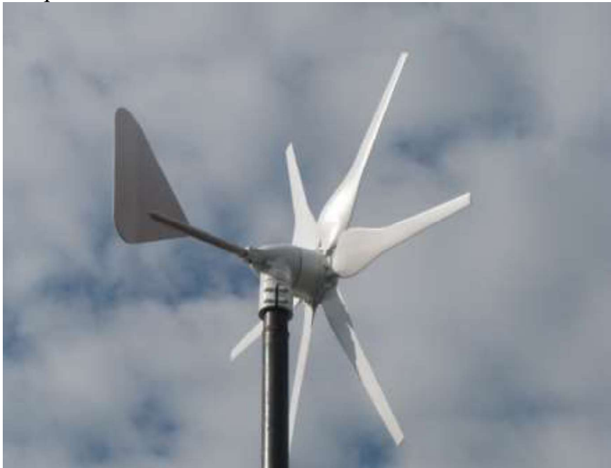
Рисунок 2 – Загальний вигляд вітрогенератора
